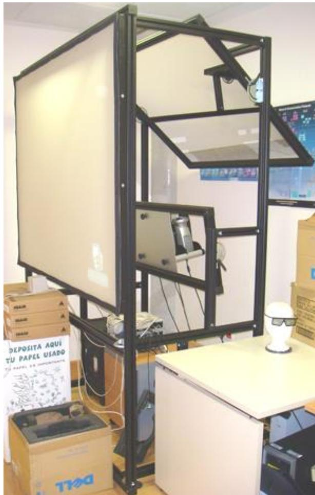
Figura 3.5. Sistema de retroproyección estereoscópico.
