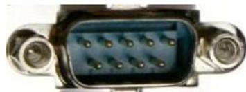
Figura 4.6. Conector del puerto RS-232 en el PC.
