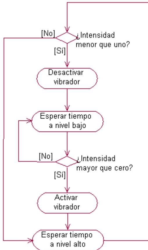
Figura 4.23. Diagrama de actividad del algoritmo PWM.
