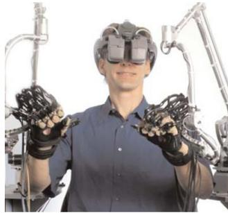
Figura 2.2. Immersion Haptic Workstation. Interfaz para Realidad Virtual inmersiva.
