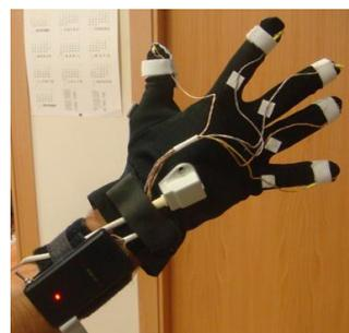
Figura 6.3. Sensor de localización en el guante con retorno háptico.
