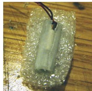
Figura 4.4. Vibrador encapsulado en una carcasa y revestido de espuma.
