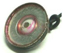
normalmente para producir sonido, pero debido a su oscilación también se pueden emplear para producir una vibración perceptible. Para su funcionamiento necesitan circuitos osciladores específicos (no se pueden conectar directamente a una fuente de tensión).
