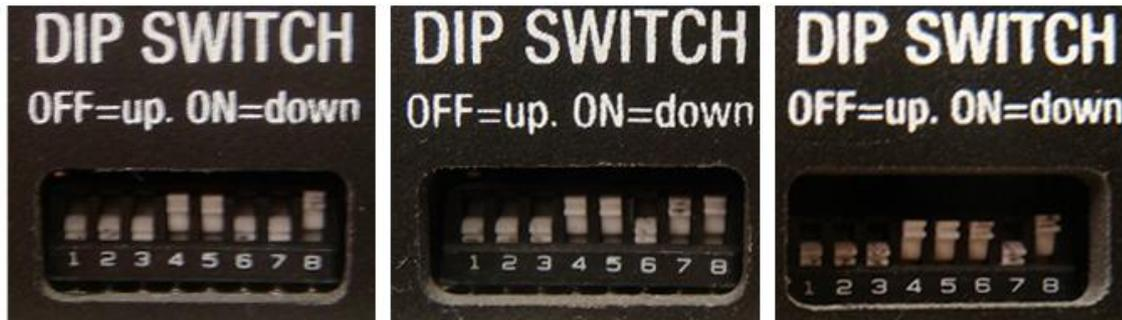
Figura C.4. Configuración de los switches de las unidades electrónicas de FOB.
