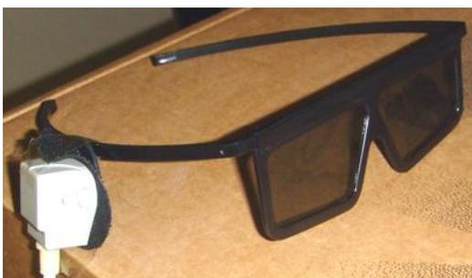
Figura 6.2. Sensor de localización en las gafas polarizadas.
