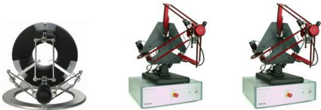
Figura 2.4. Dispositivos Omega, 3-DOF Delta y 6-DOF Delta de Force Dimension.
