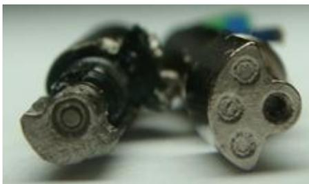
Figura 4.3. Reducción de la masa descentrada de los vibradores.
