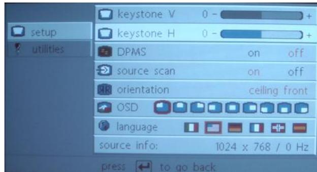
Figura B.6. Ajuste de de keystone en el menú del proyector.
