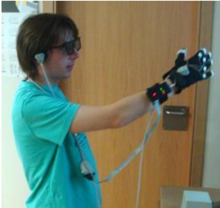
Figura 6.10. Usuario tocando el objeto virtual con el retorno háptico activado.
