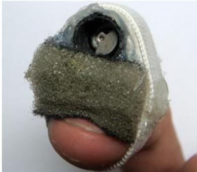
Figura 4.1. Colocación de los vibradores en el primer prototipo.
