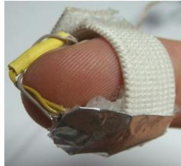
Figura 4.2. Colocación de los vibradores en la versión final.
