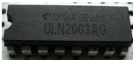
Figura 4.11. Chip integrado ULN2003.
